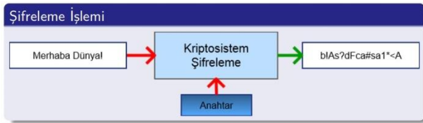
Şekil 8 Simetrik Şifreleme İşlemi
