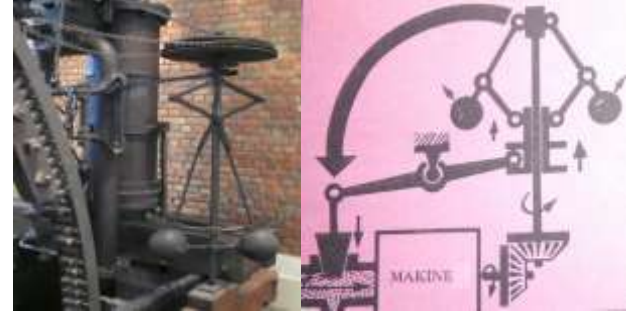
Şekil 3. Mekanik yolla yapılan geri besleme (Güvernör) ile sistemin denge durumunun otomatik olarak kontrol edilmesi.
